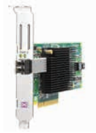
Adaptador de bus host HPE 82Q de 8 Gb de canal de fibra y puerto dual PCIe (AJ764A)
