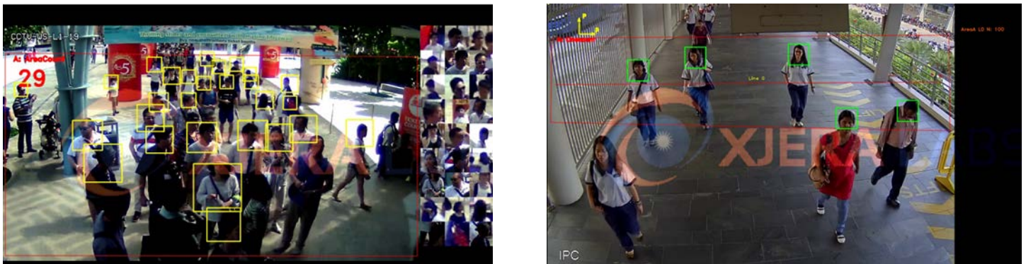
Figura 9. Il conteggio delle aree e delle persone che oltrepassano una linea effettuato da XJERA VCA
